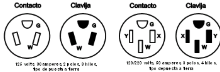
Figura 552-44(c).- Configuraciones para contactos y clavijas del tipo con puesta a tierra
